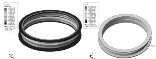
图4 膨胀节 0.6 MPa 内压与 25 mm 轴向位移应力和变形计算结果
