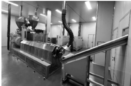
图 1 医用 PVC 压延法单螺杆挤出机组
