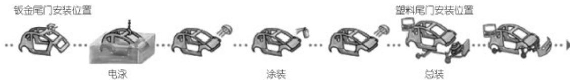
图 6 钣金尾门和塑料尾门在主机厂装配示意图
