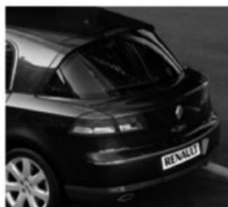
图 4 塑料尾门可集成牌照板
