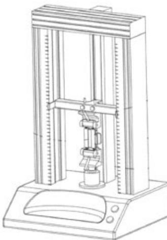
本发明提供一种橡胶拉伸性能检测机构，属于橡胶拉伸强度检测技术领域；包括安装在主机平台上的固定架，固定架上滑动连接有滑动支架，主机平台与滑动支架相互靠近一侧均安装有夹持部件，还包括用于将待测橡胶条以平直状态送入两个夹持部件内的姿态限定部件；滑动支架包括T形架。本发明通过设置姿态限定部件，实现了装夹过程中不需调节橡胶条姿态，且夹持过程中，橡胶条整体趋于平直的功能，同时，被夹持的橡胶条的两端均位于夹具内，减小了橡胶拉伸性能检测准备工作需时间，提高橡胶拉伸性能检测效率，同时，将橡胶条装夹在姿态限定部件的步骤可在前一橡胶测试过程时同步进行，进一步缩短准备工作需时间(申请专利号：CN202411303151.4)。
