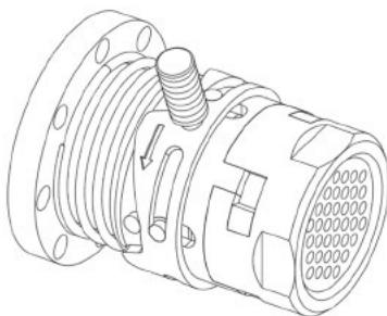
嘴根据挤出孔直径区分规格；挤出管座前端外部安装有耐高温密封圈，耐高温密封圈位于挤出模嘴内。本发明通过卡接的方式将挤出模嘴与挤出管座连接在一起，可根据所需颗粒规格大小的不同，对挤出模嘴进行更换，使挤出模嘴更换更为简便省时。解决了现有的塑料制粒用挤出机构在设计研发之初，为了保障多孔模嘴与机身连接的牢固性，多采用传统螺栓进行连接固定，当需要生产其他规格塑料颗粒时，对多孔模嘴更换繁琐费时的问题(申请专利号：CN202411028090.5)。
