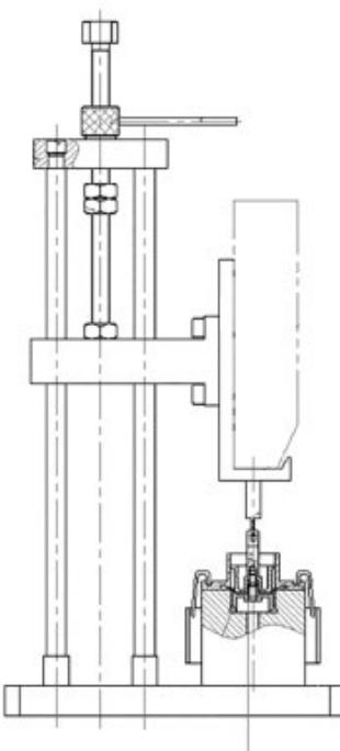
表下端具有拉钩；固定机构的上支架为碗形结构或截面U型轴对称结构，上支架与下支架的底部相对连接从而将橡胶滚动膜片夹在其中；上端盖的环形压板压在底座的上端面上，筒型结构套在上支架外侧，且环形压板具有容纳凸起密封结构的下环形槽，以及上端面的直槽；上支架与筒型结构之间的腔体容纳贴合的内环面和外环面，通过拉钩带动上支架与下支架上下移动。结构设计简单、操作方便(申请专利号：CN202211316995.3)。
