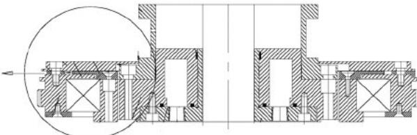
本发明公开了一种塑料造粒机旋转刀片轴承密封装置，属于塑料造粒机技术领域，解决了粉料颗粒对设备使用可靠性影响问题，其技术方案要点是包括挤料圈、冷却盘、密封套、密封板、轴承安装座、刀盘轴承、刀盘齿轮，以及旋转刀盘；挤料圈套接固定在冷却盘上，密封套嵌入固定在冷却盘内，轴承安装座位于冷却盘外侧并套接刀盘轴承，刀盘轴承外套接固定刀盘齿轮，旋转刀盘和刀盘齿轮之间设置有垫片用于留出供密封板放置的高度，旋转刀盘通过螺栓固定在刀盘齿轮上方，密封板固定在轴承安装座上并遮盖刀盘轴承，达到了微小颗粒在刀盘齿轮产生的离心力作用下，全部被抛出，达到密封轴承的效果，以及提高整体使用可靠性(申请专利号：CN202010613732.3)。
