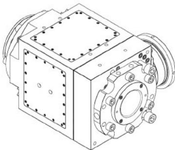
本发明涉及一种橡胶管挤出机头，解决橡胶管挤出机头胶料环向分布不均匀，影响橡胶管质量的问题。本装置机头主体设有中孔，中孔处插
