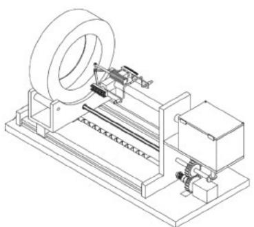
本发明涉及轮胎喷射领域，公开了一种橡胶轮胎生产用轮胎喷涂装置，包括安装框架，安装框架内部转动设置有往复螺杆和转动轴，往复螺杆表面螺纹设置有往复螺套。相较于现有技术，本申请通过清扫部件对橡胶轮胎本体内部的灰尘进行清扫，同时收集部件通过连接管道和清扫喷涂部件对清扫下的灰尘进行收集，从而使得灰尘不会重新附着在橡胶轮胎本体的内部，从而避免了橡胶轮胎本体内部附着过多的灰尘，导致灰尘会阻碍喷涂材料与轮胎内壁的充分接触，从而降低喷涂材料的附着性的情况，同时避免了
