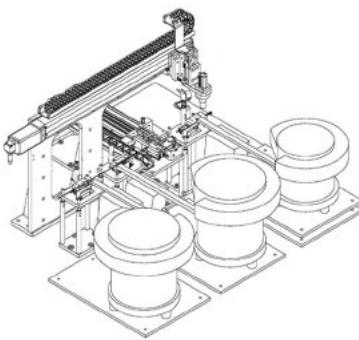
本发明公开了一种橡胶帽组件装配装置和橡胶帽组件装配方法。本发明的橡胶帽组件装配装置包括机架、压装头组件、驱动件和定位组件。压装头组件包括主体
