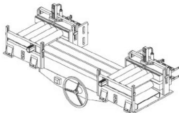
本发明涉及上料装置领域，具体为一种高回弹耐温的橡胶辊组，包括安装在镗床加工座上的辊组座，辊组座上固定安装有下水箱以及下边板，辊组座上升降安装有上水箱和上边板，下水箱和下边板之间转动安装有支撑辊，上水箱和上边板之间转动安装有支撑辊和推动辊；支撑辊和推动辊的结构相同，上水箱通过直线轨道控制升降，上水箱、下水箱、支撑辊以及推动辊中装有冷却水，上水箱顶部设置有与其连通的监测管，监测管中设置有浮球，检测管的顶部设置有能够被浮球触发的副开关，副开关能进行直线轨道的控制，上水箱和下水箱侧面安装有散热管，散热管中设置有位置可调的活塞结构；达到自动控制橡胶辊压力、提高橡胶辊组耐温能力的目的(申请专利号：CN202411094399.4)。
