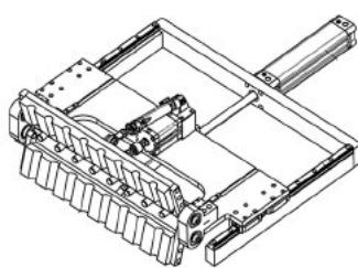
本发明涉及一种橡胶套管脱模机械手，包括用于夹住橡胶套管的夹持装置、用于向橡胶套管和模芯之间充气的充气装置，夹持装置包括第一夹板、第二夹板、第一驱动组件、多个第一容纳部、多个第二容纳部，多个第一容纳部、多个第二容纳部、模芯一一对应，当第一夹板和第二夹板相互靠近时，橡胶套管位于第一容纳部和第二容纳部之间；充气装置包括第一支撑板、多个吹气筒、第二驱动组件，吹气筒与模芯一一对应，吹气筒具有插接头以及气道。本发明能够快速脱模取件，且能够同时脱出多个橡胶套管，实现全自动化无人生产，减少人工劳动力，提高生产效率(申请专利号：CN201810902258.9)。
