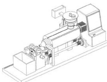
本发明公开了一种橡胶密封圈生产用挤塑机上料装置，属于橡胶密封圈加工技术领域，该橡胶密封圈生产用挤塑机上料装置，包括工作底板，工作底板上方设置有上料箱组件，工作底板上方分别安装有与上料箱组件两端相对应的自动开合机
