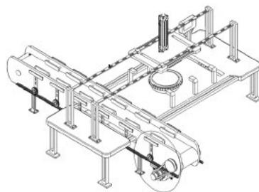
动盘的上方，用于夹持不同尺寸大小的橡胶密封圈；纠偏组件，其安装在安装架转动盘的外部，用于纠偏运输橡胶密封圈运输状态。通过增设自动纠偏组件能够快速响应运输带上的橡胶密封圈位置偏移，自动调整圈的位置，从而减少了人工干预和生产中断的需求，提高了装配的整体效率，同时自动纠偏组件的使用使得整个自动装配系统更加流畅和可靠(申请专利号：CN202411151465.7)。
