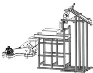
出料端连通，转运套筒出料端与破碎机进料端之间设置有转运机构，转运机构固定安装于机架上。该塑料颗粒破碎用原料处理机构，利用离心分离机构以对塑料瓶内的食物残渣进行分离处理，并在滤孔的作用下将食物残渣排入至收集仓室内进行收集，从而有效降低食物残渣对破碎机造成的影响(申请专利号：CN202411265931.4)。
