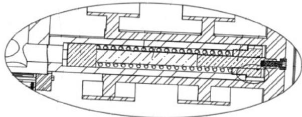
本发明涉及硅橡胶制备设备相关技术领域，具体为一种硅橡胶制备用原料精准混配设备及生产工艺，硅橡胶制备用原料精准混配设备包括混料罐、升降模组、安装梁、搅拌轴和搅拌杆，混料罐通过支腿安装在设备底座上；通过设置由混料罐、升降模组、安装梁、搅拌轴和搅拌杆组合构成的硅橡胶制备用原料精准混配设备，并在搅拌轴上开设主气道，并在搅拌杆上开设二级气孔、活塞腔，并在活塞腔之中设置活塞、一级活动杆、二级活动杆、支撑弹簧，从而通过向主气道之中充气，从而让活塞外移，从而让装置在自清洁时，可以推动一级刮刀座上的刮刀组件外移，从而通过刮刀组件外对混料罐的内侧壁形成辅助清理
