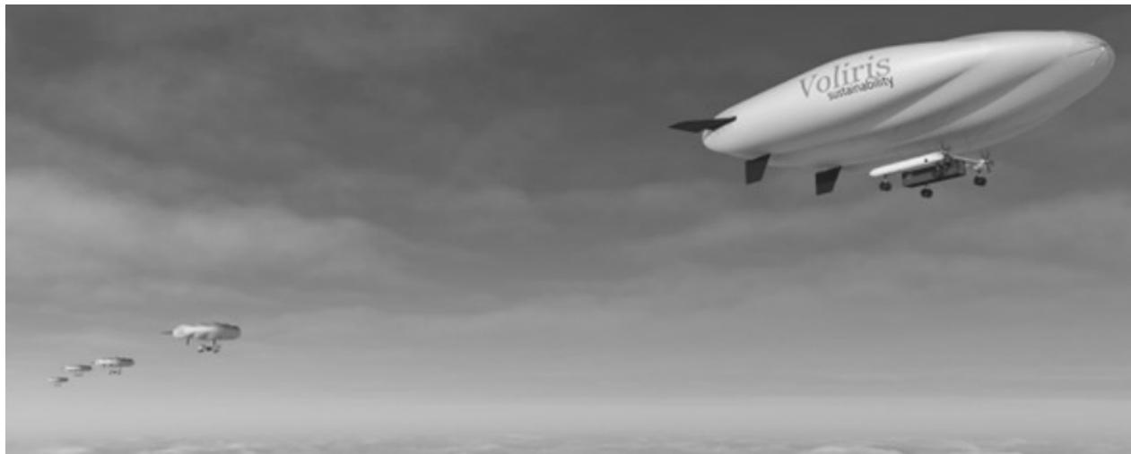
NATAC氢动力自动货运飞艇融合了飞艇和货运飞机的优势，采用氢气作为动力和升力来源，能够实现100%零碳排的货物运输。与传统飞机不同，NATAC无需铺设跑道，即可在基础设施有限的地区起降，有望大幅减少土地开发对环境的影响。
