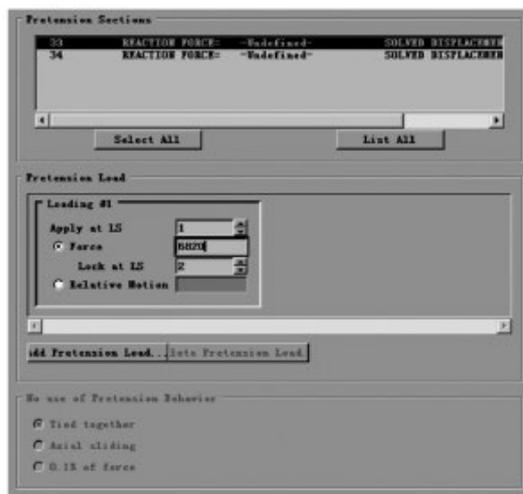
图 11 螺栓预紧力加载
