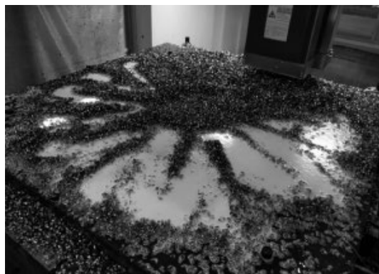
图 4 数控龙门加工中心水冷加工方式
