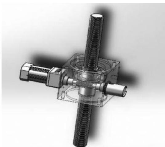
图 4 新型后充气装置调模结构
