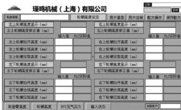
图 6 后充气装置参数画面
