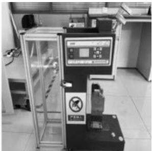
图 3 简支梁冲击试验
