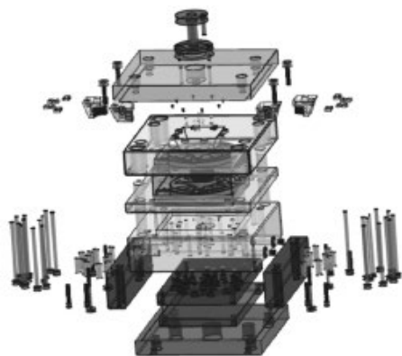
图5 塑件注射成型模具总装图(爆炸图)
