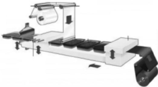
图 6 下吹工艺生产的拉伸底膜
