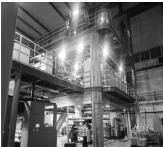
图10 生产中的11层共挤下吹先进装备
