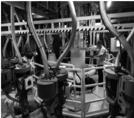
图1 上吹9层共挤设备挤出系统
