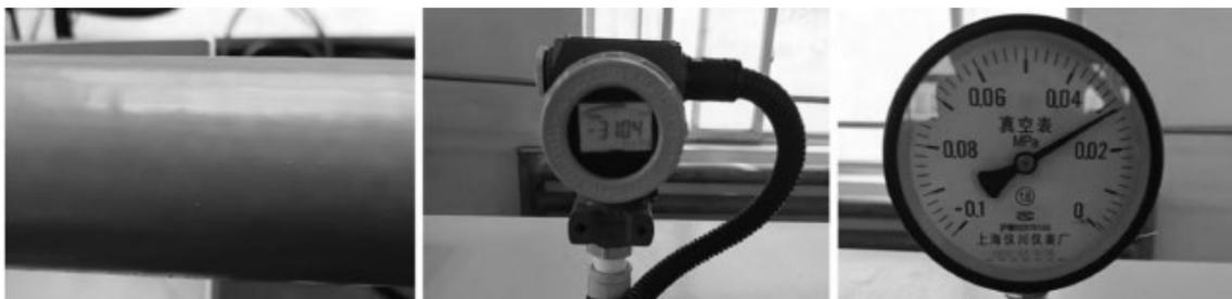
图 10 真空定径水箱压力对管材外壁的影响
