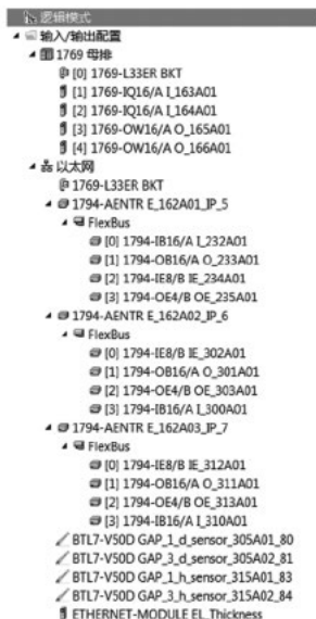
图 1 液压调距电气系统硬件组态图
