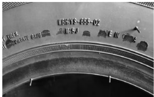
图6 胎侧小字体缺胶示例图
