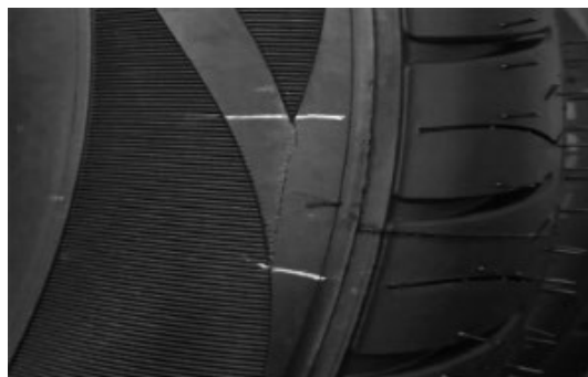
图 1 侧翼端点缺胶示例图
