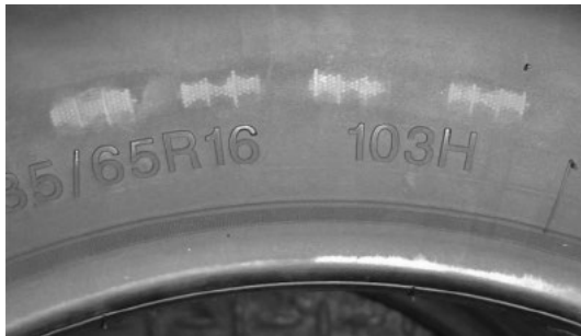
图4 胎侧三角胶端点缺胶示例图
