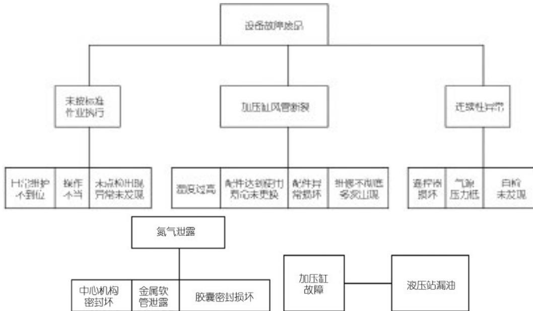
图 3 设备问题关联图分析
