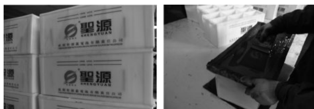
图4 蓄电池槽印字与丝网油印示意图
