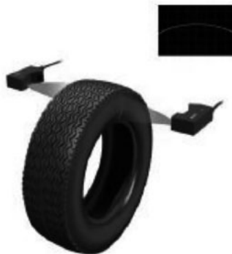
图2 线激光检测原理图
